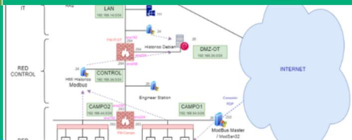
Integración del prototipo "físico" en el entorno virtualizado
